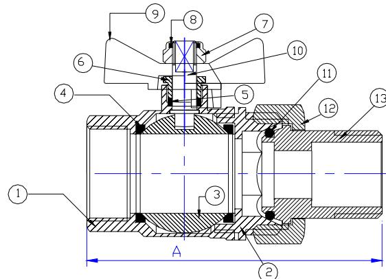
Корпус крана выполнен из двух деталей 1 и 2, соединенных между собой на резьбе с проклейкой пропилметакрилатным клеем анаэробного твердения Loctite 620 (допущен для контакта с пищевыми жидкостями). Запорный орган крана представляет из себя латунный хромированный шар 3, приводимый в движение латунным штоком 10. В качестве седельных уплотнений использованы тефлоновые кольца 4. Сальниковая гайка 6 с помощью сальниковой прокладки из тефлона 5 обеспечивает герметичность штока.
