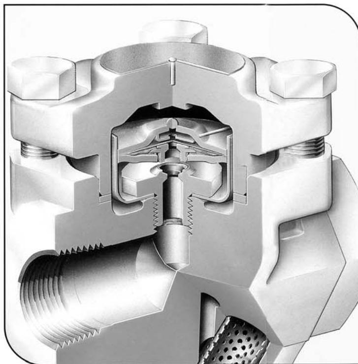
Корпус диска обеспечивает поддержку мембраны
