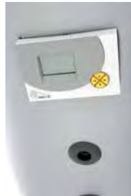
Электронный одианный контроллер солнечными батареями с графическим дисплеем
