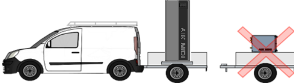
Схема 4.1-1 Транспортування теплового насосу
