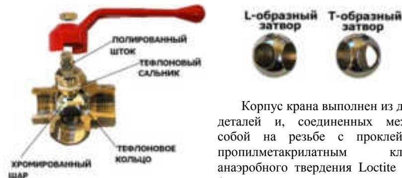
Корпус крана выполнен из двух деталей и, соединенных между собой на резьбе с прокладкой пропиленакрилатным клеем анаэробного твердения Loctite 620 (допущен для контакта с пищевыми жидкостями). Запорный орган крана представляет из себя латунный хромированный шар, приводимый в движение латунным штоком. В качестве седельных уплотнений использованы тефлоновые кольца. Сальниковая гайка с помощью сальниковой прокладки из тефлона обеспечивает герметичность штока.
