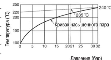
ПРЕДЕЛЬНЫЕ ПАРАМЕТРЫ КОНСТРУКЦИИ КОРПУСА (НЕ РАБОЧИЕ УСЛОВИЯ): Максимальное Допустимое Давление (бар) Pmax: 32
