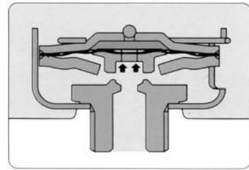
При запуске парового оборудования, когда капсула все еще охлаждена, жидкость-наполнитель находится в жидком состоянии. Внутреннее давление меньше, чем внешнее, поэтому мембрана поднята вверх и клапан открыт. В это время выводятся воздух, посторонние газы и оставшийся конденсат.
