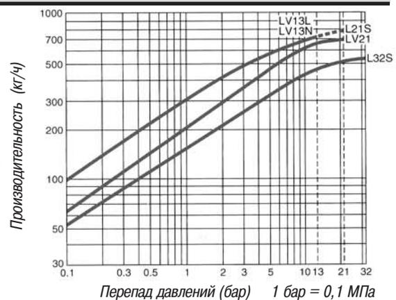
1. Перепад давлений - это разница между входящим и исходящим давлением в кондотводчике.
