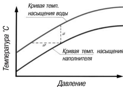
Элемент капсулы содержит в себе жидкость, температура насыщения которой немного ниже, чем температура насыщения воды. Когда в конденсатоотводчике повышается температура, жидкость-наполнитель испаряется, и образовавшееся высокое внутреннее давление расширяет
