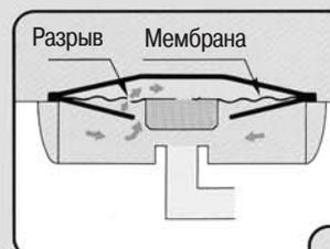
1. Если мембрана ломается, жидкость, находившаяся внутри нее вытечет, создав таким образом первичное давление P1 в элементе над мембраной.
