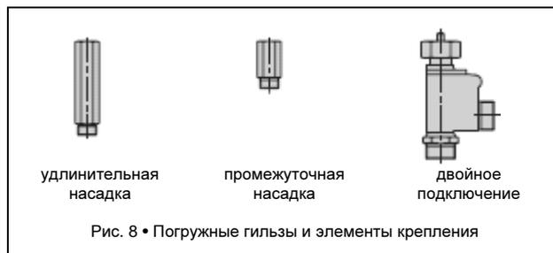
Промежуточная насадка из коррозионно-стойкой стали отделяет рабочий элемент из цветных металлов от среды, действующей в регулирующем клапане. Кроме того, она препятствует выходу среды при замене термостата.
