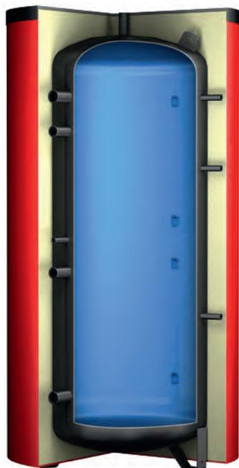
Бак-аккумулятор для накопления горячей санитарной воды в плотной полиуретановой изоляции, с внешней облицовкой из красного ПВХ. Бак снабжен магниевым защитным анодом и ревизионным фланцем.
